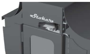
Рисунок-15. Установка датчика тяги. Закрепить датчик тяги саморезом. Кабель датчика спрятать за передним кожухом
